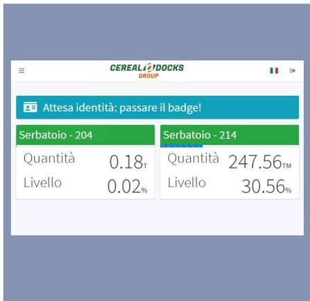
Dove previsto vengono utilizzati ulteriori **schermi web** per il collegamento all'impianto di dosaggio e lo sblocco delle operazioni interne allo stabilimento. Anche in questo caso è sempre il badge a rappresentare l'identità del trasportatore e permettere, o meno, la partenza delle diverse operazioni.
