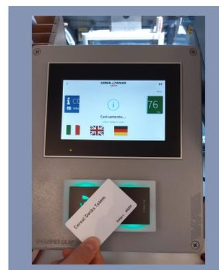
In questa fase l'utente viene guidato tramite un semplice flusso, a confermare la propria identità ed effettuare la prima pesata. Nel caso di scarico, vengono prelevati dei campioni ed effettuati dei controlli di qualità che il sistema importa dal dispositivo di controllo.
